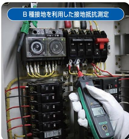
B種接地を利用した接地抵抗測定
