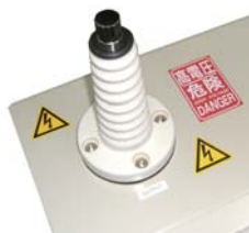
【高圧出力部】 (碍子部分)
