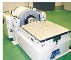
動電式振動試験装置
