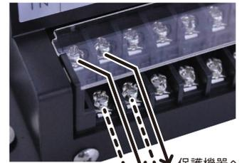
信号・電話回線・制御電源回路
