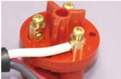
■ スリーブネジ締め付 細い電線は2つ折りに！
