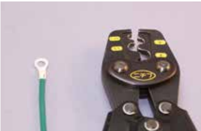
■ 圧着端子 適正な圧着工具で！
